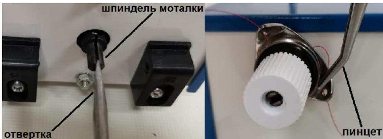
Вставьте вилку шнура питания моталки в розетку. Нажмите клавишу включения питания слева на корпусе моталки. Нажмите кнопку «Пуск». Моталка начнет наматывать нитку на шпульку и автоматически остановится при окончании намотки. Снимите шпульку со шпинделя моталки и обрежьте нить ножницами.
